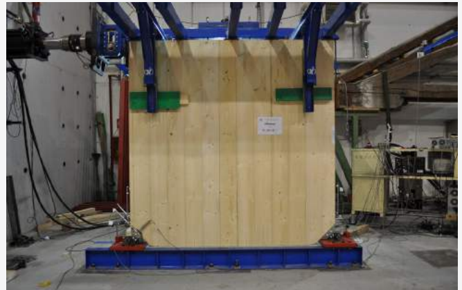
Beispiel für das Ergebnis eines zyklischen Versuchs an einem Wand-System: Diagramm Kraft-Belastung und Einrichtung des Versuchs an steifer Platte
