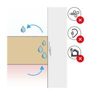
En l'absence de ces trois niveaux, la probabilité de condensation et d'infiltration d'eau dans la structure est élevée.
