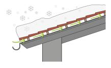
En hiver, la ventilation permet une fonte uniforme de la neige éventuellement accumulée sur le toit, évitant les glissements incontrôlés.
