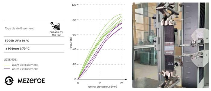
\*FACADE BAND UV fait partie de la même famille des produits de FLEXI BAND UV. Par rapport à FLEXI BAND UV, le FACADE BAND UV se distingue par un support présentant une majeure stabilité aux UV grâce à l'ajout d'additifs spécifiques. Par conséquent, les résultats sont également représentatifs de ce produit.
