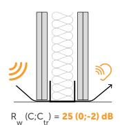
panneaux en placoplâtre avec FIRE SEALING SILICONE pour restaurer le pouvoir insonorisant
