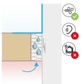
Le risque que l'air interne, chargé d'humidité, pénètre dans les ioints et forme de la condensation au niveau intermédiaire est élevé.
