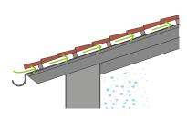
Une bonne ventilation favorise le séchage de la vapeur d'eau présente à l'intérieur de l'enveloppe du bâtiment, évitant la formation de condensation interstitielle au niveau de l'isolant et de la structure.
