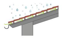
La couche de ventilation offre une protection supplémentaire en cas d'infiltrations accidentelles, car elle crée une deuxième couche d'écoulement de l'eau et l'empêche de stagner.
