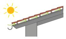
Pendant les mois les plus chauds, la ventilation évacue une partie de l'énergie thermique accumulée sous le revêtement, en contribuant à l'amélioration du confort de vie.
