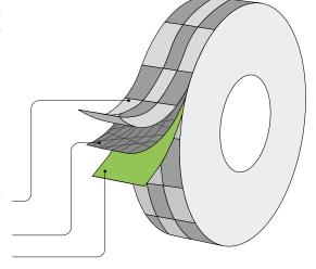
**CARRIER** (stabilité et résistance mécanique) GRILLE (résistance mécanique) COLLE (adhérence)
