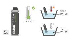
Pour un rendu optimal, travailler à une température ambiante d'environ + 20 °C. Conseil : plonger la bombe dans de l'eau tiède ou froide pour augmenter ou diminuer la température du mélange.
