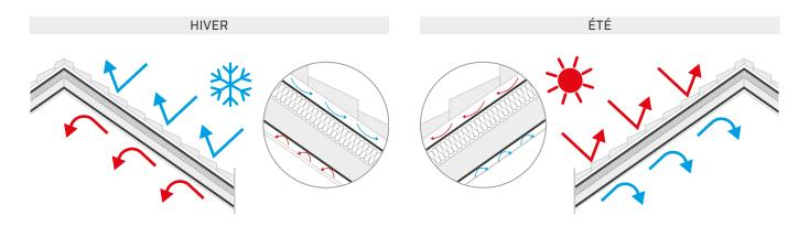
En hiver, les membranes avec la finition en aluminium, appliquées à l'intérieur et couplées à une lame d'air réfléchissent la chaleur vers l'intérieur, en transformant l'interstice en couche isolante et en augmentant les performances thermiques.
