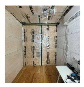
CLIMA CONTROL a été installé aussi bien sur le mur que sur la toiture pour tester son efficacité dans différentes conditions
