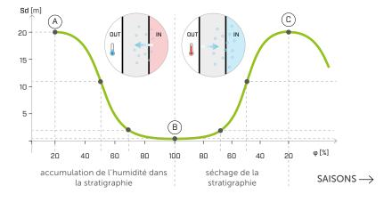
(A) STRATIGRAPHIE SÈCHE: Sd 20 m <u>protection maximale</u> - frein vapeur pour limiter le passage de la vapeur au vu de la
