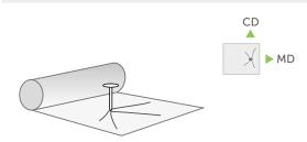
Force exercée longitudinalement et transversalement avec l'insertion d'un pointe pour déterminer la charge maximale exprimée en N (Newton).
