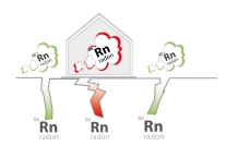
Le radon devient dangereux s'il s'accumule à l'intérieur des habitations. Aujourd'hui, avec l'intérêt majeur que l'on a pour les bâtiments à basse consommation d'énergie (et donc avec une meilleure qualité de la couche d'étanchéité à l'air) et pour la diminution de la ventilation naturelle qui en découle, les risques posés par le radon représentent un thème tout à fait actuel.
