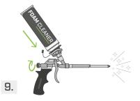
Ne pas oublier de nettoyer également l'intérieur du pistolet. Après avoir agité vigoureusement FLYCLEAN, visser le nettoyant sur le pistolet et extruder le produit jusqu'à ce que la mousse polyuréthane soit complètement sortie.
