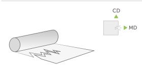
Force exercée longitudinalement et transversalement pour déterminer la charge maximale exprimée en N/50 mm.
