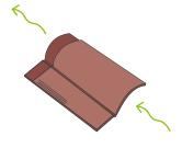
La micro-ventilation qui se crée sous les tuiles est favorisée par la géométrie de la tuile. Elle suffit pour l'élimination de l'excès d'humidité.
