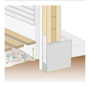
Pour éviter que la base du bâtiment entre en contact avec le sol humide, la structure en bois doit être installée à un niveau plus élevé que celui de l'écoulement des eaux.
