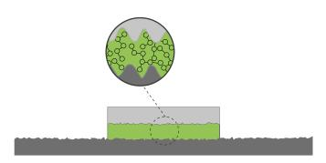
L'adhésif est capable d'exploiter la rugosité de la surface en pénétrant les micropores pour créer l'adhérence.
