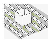
Éviter les litelages ou autres entraves susceptibles de gêner le flux ascensionnel de l'air réchauffé à travers le pan.
