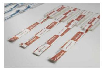
L'exposition en milieu extérieur permet de tester la résistance aux agents atmosphériques, en évaluant l'effet combiné des rayons UV, de l'humidité, de la chaleur et de la pluie.
