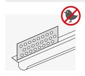
Protéger les points de prise et de sortie de l'air entrant contre les insectes et les volatils, en minimisant l'obstruction de la section.
