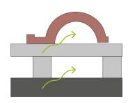
La ventilation sous le revêtement est assurée par les liteaux de support des tuiles et, outre l'élimination de l'humidité, elle assure également l'élimination de la chaleur accumulée excessive.
