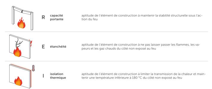
La classe de résistance au feu est exprimée en minutes, pendant lesquelles la résistance sous l'action des flammes doit être assurée: 15, 20, 30, 45, 60, 90, 120, 180, 240 et 360 minutes. L'indication des minutes suit le sigle REI (par ex, REI120). Dans le cas de structures non porteuses, où la capacité porteuse ne représente pas une donnée significative, il est possible d'omettre le facteur R et d'exprimer l'indication des minutes avec les initiales EI (par ex, EI90).
