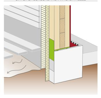
Souvent, il s'agit de l'un des points les plus froids du bâtiment, c'est pourquoi il est important de résoudre le pont thermique et d'assurer l'étanchéité à l'air.
