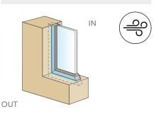
Le niveau le plus extérieur doit garantir l'étanchéité aux agents atmosphériques. S'il n'est pas correctement traité, il peut entraîner des problèmes d'infiltration et d'accumulation d'eau stagnante dans la partie inférieure du trou de la fenêtre.
