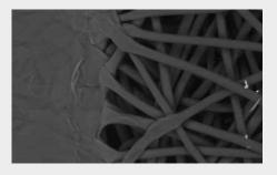
Image obtenue au microscope électronique à balayage avec un grossissement de 500x de la surface en TnT d'une de nos membranes. Cette image est utile pour une analyse préliminaire des effets du vieillissement.
