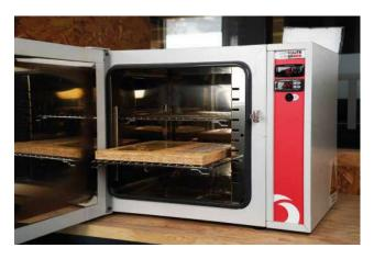
Par le test Martindale, nous étudions la résistance à l'usure et à la rupture de nos membranes. Avec les fours et les chambres à basse température, nous testons le comportement de nos produits lorsqu'ils sont exposés à des températures extrêmes.
