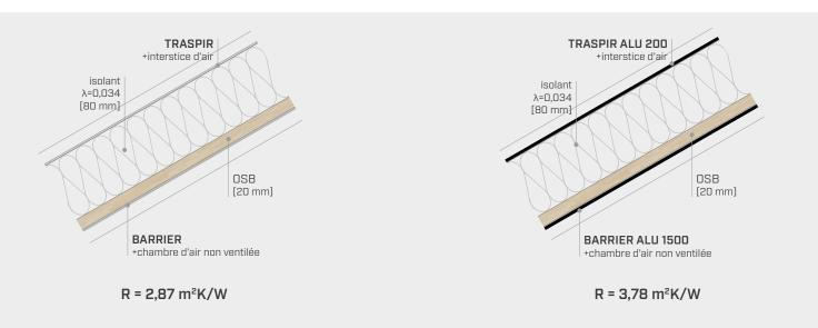
Dans cet exemple de calcul, l'utilisation des membranes réfléchissantes offre une augmentation de 32 % de la résistance thermique de la stratigraphie et une augmentation des performances globales du système de construction.
