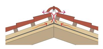
Pour la création d'une entrée d'air correcte à proximité de la ligne de faîtage, il est conseillé d'utiliser des solutions qui permettent le passage de l'air. Rothoblaas propose des closoirs ventilés rigides ou flexibles.
