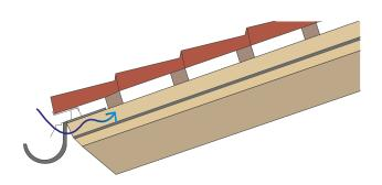
Le moyen le plus efficace de réaliser une entrée d'air correcte près de la ligne de gouttière est d'utiliser tous les produits qui permettent à l'air d'entrer mais qui protègent la toiture des intrusions d'oiseaux et de petits animaux. Parmi les différentes solutions proposées par Rothoblaas : les grilles de ventilation et les peignes pare-moineaux illustrés dans ce chapitre.
