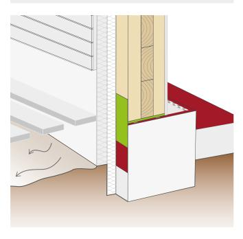
Pour éviter la migration de l'humidité du béton vers le mur en bois, une barrière étanche doit être placée entre le béton et la structure en bois
