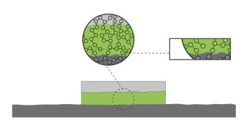
La composition chimique particulière de l'adhésif permet d'établir des interactions secondaires avec la surface, en exploitant un mécanisme similaire à celui qui permet à un gecko de marcher sur la vitre d'une fenêtre. Cette propriété augmente considérablement l'adhérence du ruban.
