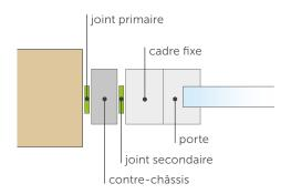
Le JOINT PRIMAIRE représente le premier nœud de pose entre structure et contre-châssis. Le JOINT SECONDAIRE représente en revanche le nœud de pose entre contre-châssis et châssis de la menuiserie.
