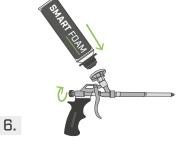
Avant d'insérer la bombe dans le pistolet (COD. FLYFOAM), vérifier qu'il n'y ait pas de résidus de mousse de l'application précédente. Les pistolets sont équipés d'une valve spécifique qui régule la pression d'extrusion, pour doser la mousse avec précision.
