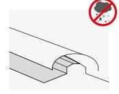
Assurer l'étanchéité à l'eau et à la neige entraînée par le vent au niveau du faîtage.
