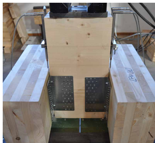
Campioni di prova: pannelli X-LAM 5 strati angolari TITAN con fissaggio totale TTF200 - TTN240 - TTS240 - TTV240 profilo resiliente XYLOFON 35
