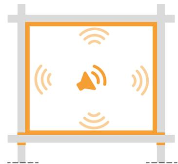
El correcto diseño de los trasdosados y, si es el caso, de los falsos techos permite atenuar cualquier tipo de propagación del ruido y evitar la transmisión del ruido aéreo generado en la habitación.
