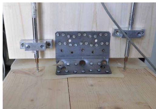
Prueba de resistencia a la tracción monótona ( $F_1$ ) en NINO15080 en configuración madera-madera.
