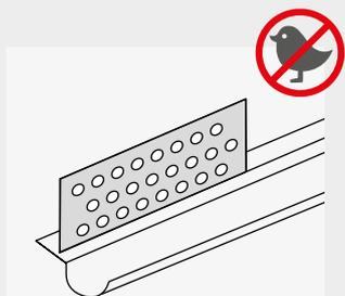
Защитить точки входа и выхода воздуха от проникновения насекомых и птиц, минимизируя таким образом блокирование прохода.
