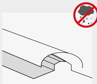
Обеспечить непроницаемость для воды и снега, наносимых ветром под конек.
