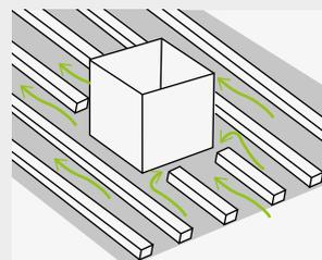
Обойтись без обрешетки или других элементов, мешающих подъему нагретого воздуха через скат крыши.
