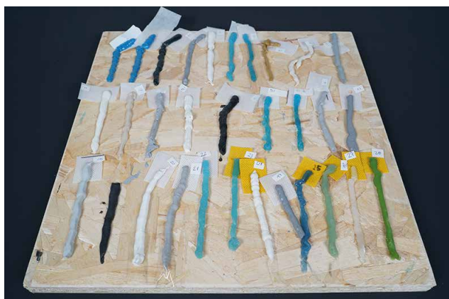
Testování za účelem posouzení přilnavosti, soudržnosti a elasticity různých lepidel a těsnících prostředků.
