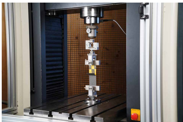
Testování soudržnosti a přilnavosti našich akrylových lepicích pásek na různé podkladové materiály.
