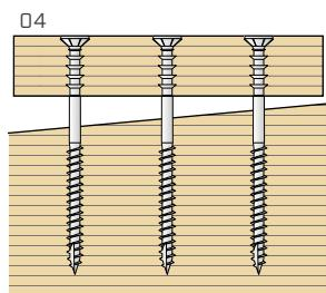
Regolare in maniera analoga le altre viti per livellare la struttura.
