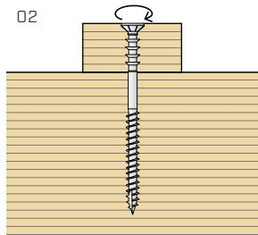
Fissare il listello avvitando la vite in maniera tale che la testa risulti a filo dell'elemento in legno.
