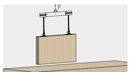
(\*) Nel caso di sollevamento da posizione orizzontale, per viti con L > 300 mm la resistenza in fase di "ribaltamento" diventa governante. In questo caso, la resistenza dovrà essere ridotta applicando un coefficiente riduttivo 0,8.
