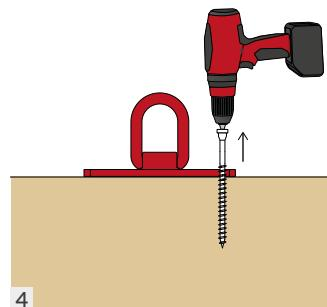
Leggere con attenzione le istruzioni per l'uso e rispettarne le indicazioni. Il posizionamento della piastra sull'elemento in legno da movimentare deve rispettare le distanze minime raccomandate.
