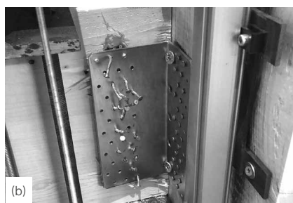
Moște la sfârșitul încercărilor ciclice: tracțiune (a), forfecare (b) și 45° (c) (fixare parțială).
