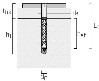
**d<sub>0</sub>** diamètre ancrage = diamètre de perçage dans le support en béton
