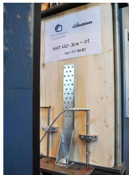
Experimentell kampanj på panelerna CLT (C24) (CNR-IBE i San Michele All'Adige, 2020).
